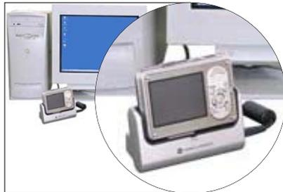
Übertragung des Updates mit der an den Computer angeschlossenen DiMAGE X1 (über die Basisstation CA-1).
