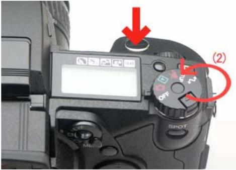
(1) Setzen Sie die vorbereitete CompactFlash-Karte in die DiMAGE 7Hi ein. Drücken Sie den Auslöser herunter, während sich das Funktionsrad in der Position "OFF" befindet.
