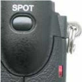
(3) Die Zugriffsanzeige leuchtet für ca. zwei Minuten. (Sie können den Auslöser loslassen, sobald die Zugriffsanzeige leuchtet.)
