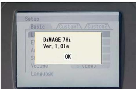
(5) Kontrollieren Sie, welche Versionsnummer auf dem LCD-Monitor angezeigt wird, wie im Abschnitt "Überprüfen der Firmwareversion" beschrieben. Wurde die Versionsnummer in Ver.101e geändert, war das Update erfolgreich.
