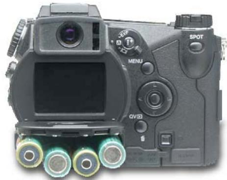
(4) Wenn die Zugriffsanzeige nicht mehr leuchtet, ist der Update-Vorgang abgeschlossen. Entfernen Sie die Batterien und setzen Sie diese danach wieder ein. Wenn Sie ein Netzteil verwenden, trennen Sie dieses von der Kamera und entfernen Sie ebenfalls Batterien oder Akkus, falls sich diese noch in der Kamera befinden.
