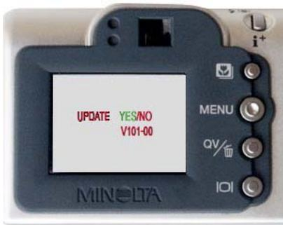
1. Setzen Sie die vorbereitete SD-Speicherkarte in die DiMAGE F100 ein, und trennen Sie die Kamera vom Netzteil bzw. entfernen Sie die Akkus/Batterien. Drehen Sie das Funktionsrad (Hauptschalter) auf die Position „Wiedergabemodus“. Schließen Sie nun das Netzteil an oder setzen Sie die Akkus/Batterien ein.
