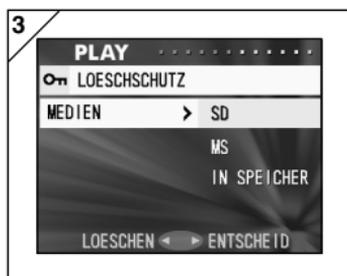
3. Wählen Sie mithilfe von ▼ oder ▲ das Medium aus, auf dem das Bild, das geschützt bzw. dessen Schutz aufgehoben werden soll, gespeichert ist, und drücken Sie dann ► oder MENU/SET. Die Einstellung ist damit abgeschlossen, und Sie kehren zu Bildschirm 2 zurück.
