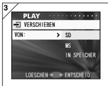
3. Wählen Sie mithilfe von ▼ oder ▲ das Medium aus, auf dem das zu verschiebende Bild gespeichert ist, und drücken Sie dann ► oder MENU/SET. Die Einstellung ist damit abgeschlossen, und Sie kehren zu Bildschirm 2 zurück.
