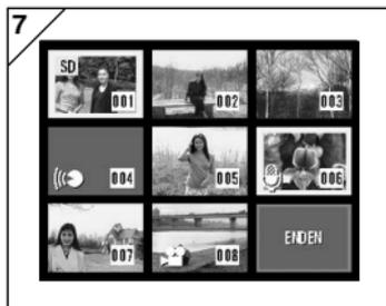
7. Die in Schritt 6 ausgewählten Bilder sind von einem gelben Rahmen umgeben. Nachdem Sie die Bildauswahl abgeschlossen haben, wählen Sie mithilfe von ◀, ▶, ▲ oder ▼ „ENDEN“ aus, und drücken Sie dann die MENU/SET-Taste. (Fahren Sie mit Schritt 8 fort.)
