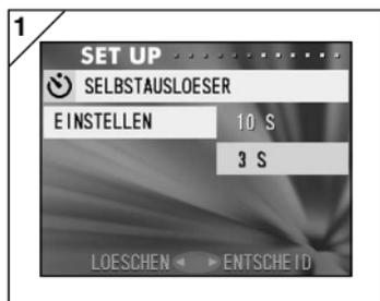
1. Wählen Sie „SELBSTAUSLOESER“, und drücken Sie ►, um den Einstellungsbildschirm aufzurufen. Wählen Sie mithilfe von ▼ oder ▲ „3 S“ aus, und drücken Sie ► oder MENU/SET. Die Einstellung ist damit abgeschlossen, und Sie kehren zum SET-UP-Menü zurück.
