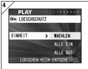
4. Drücken Sie auf Bildschirm 2 mit der Einstellung „EINHEIT“ zunächst ►, und verwenden Sie dann ▼ oder ▲, um „WAEHLEN“ auszuwählen, wenn Sie ein oder mehrere Bilder schützen bzw. deren Schutz aufheben möchten. Sollen alle Bilder geschützt werden, wählen Sie „ALLE EIN“ aus.
