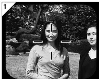
1. Richten Sie die Autofokus-Markierung am Motiv aus, und drücken Sie den Auslöser halb herunter. Die grüne LED leuchtet auf, und die Scharfeinstellung wird gespeichert.
