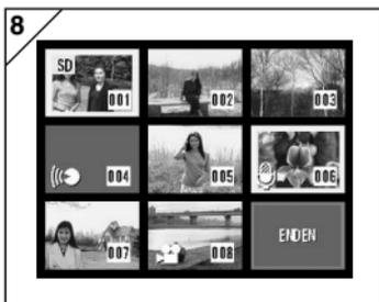
8. Die in Schritt 7 ausgewählten Bilder sind von einem gelben Rahmen umgeben. Nachdem Sie die Bildauswahl abgeschlossen haben, wählen Sie mithilfe von ◀, ▶, ▲ oder ▼ „ENDEN“ aus, und drücken Sie dann die MENU/SET-Taste. (Fahren Sie mit Schritt 9 fort.)
