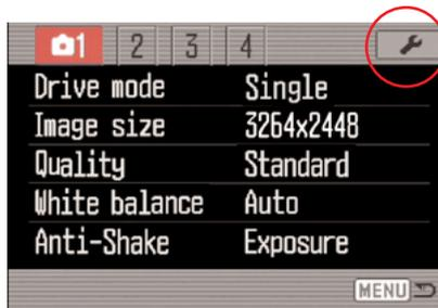
4. При помощи кнопок контроллера “влево” / “вправо” выберите закладку 4. Затем при помощи кнопок контроллера “вверх” / “вниз” выберите пункт “Версия ПО” (“Firmware ver.”).
